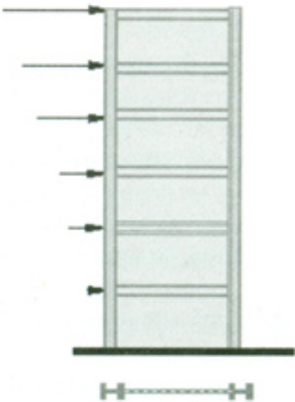
Şekil-2: Çelik levha perdeli çerçevenin ana elemanları; kolonlar, kat kirişleri ve çelik levhalar.
