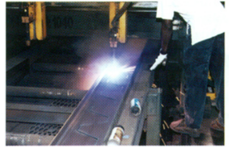
Resim 6: Hadde profilinin yarı otomatik kesimi
