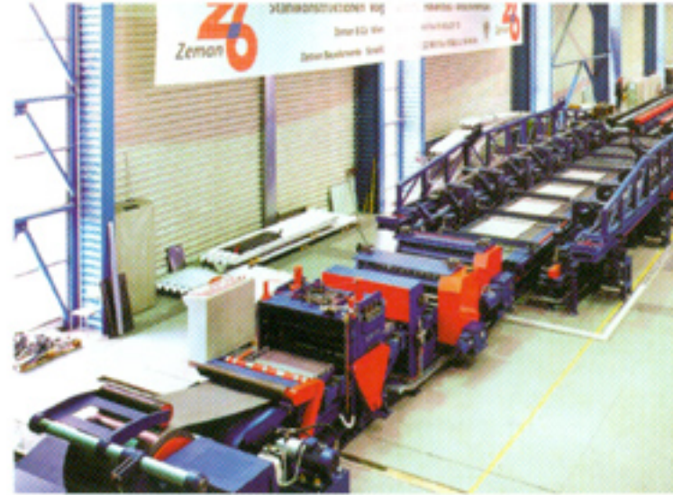
Şekil-2 Rulo halindeki ince sacın soğuk şekillendirilmesi (www.zeman-stahl.com)
