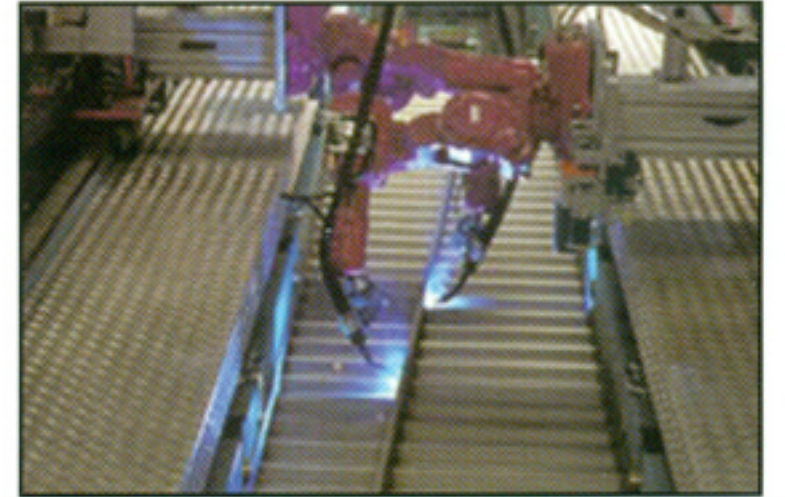
Şekil 3 Başlık levhalarının şekillendirilmiş gövdeye kaynaklanması (www.zeman-stahl.com)
