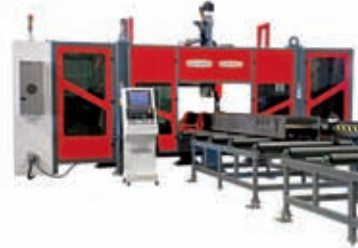
3ADM 1200 CNC Delik Delme - Markalama Kesme Hattı
