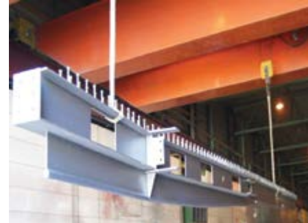
Resim 10. DEXIA-BİL Binası A Blok; özel şekillendirilmiş kompozit döşeme kirişi
