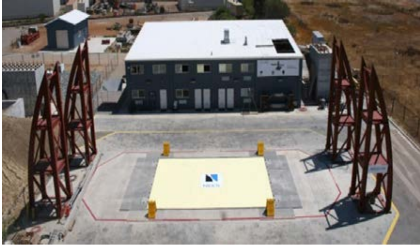
Resim 3 – Doğu – Batı Ekseninde Hareketli (Tek Eksenli) 4,2 g Azami İvme ve 1,8 m/s Azami Hıza Sahip, 12,2 m x 7,6 m Boyutlarındaki Sarsma Tablası
