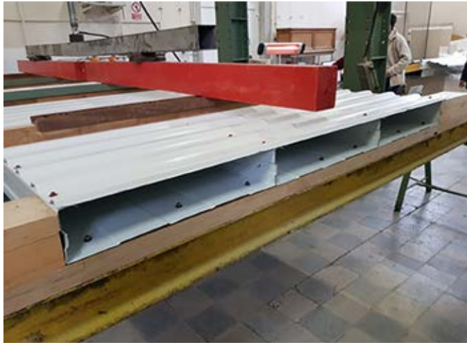
Şekil 16 - Kaplamanın dış cidar levhasının montajı
