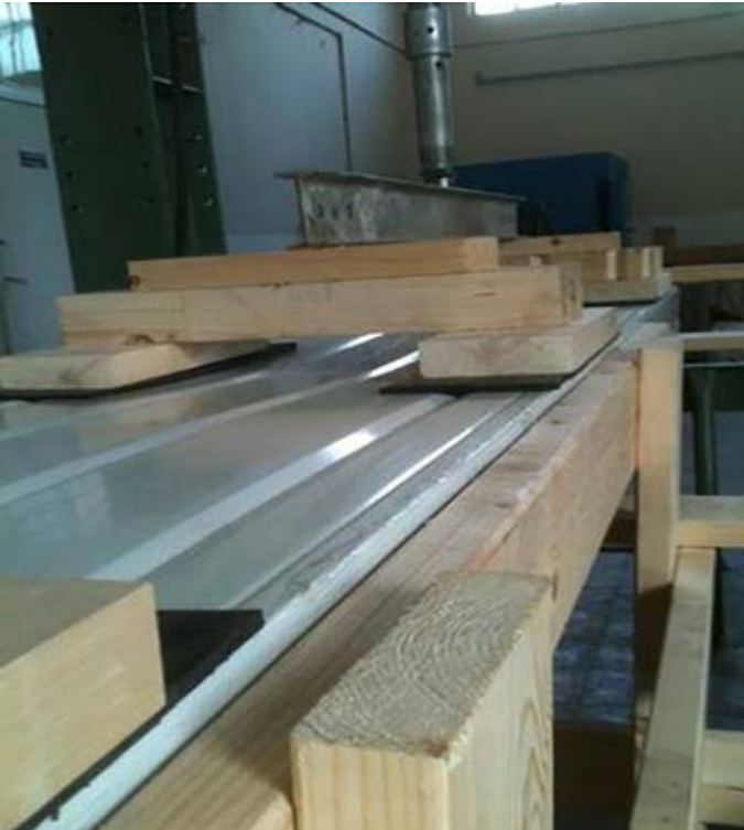
Şekil 6 - Nokta yükünün kauçuk tabaka ile düzgün iletimi
