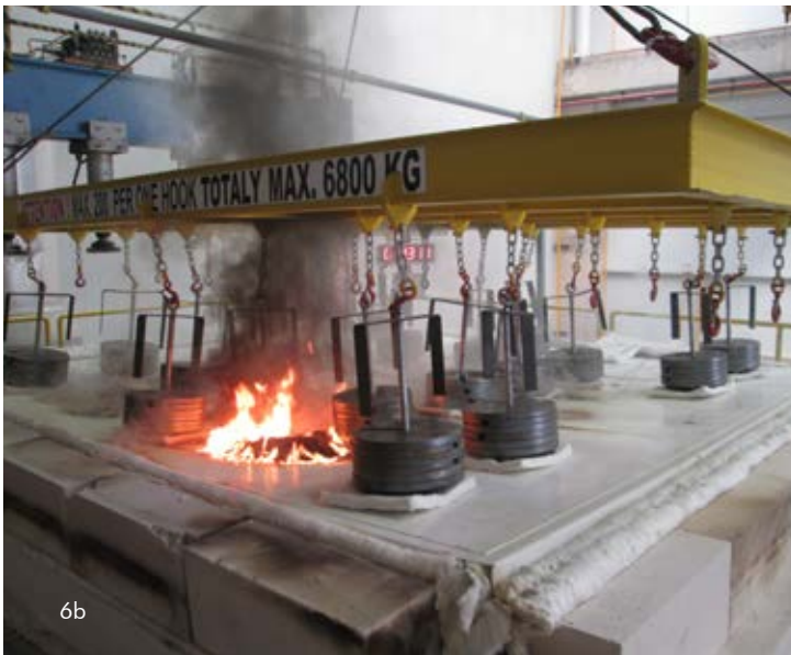
Şekil 6 - Yük Taşıyan Döşeme Elemanı Testleri (Test Başlangıcı ve Sonu))
