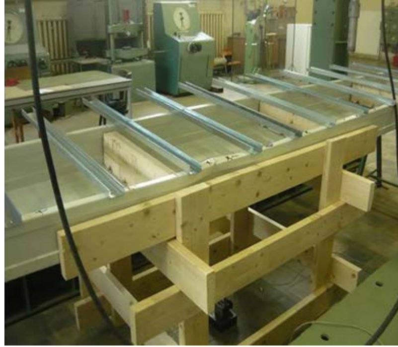
Şekil 7 - Orta açıklıkta tipik simetrik olmayan başarısızlık (dış kaplama üzerindeki rüzgâr basıncı)
