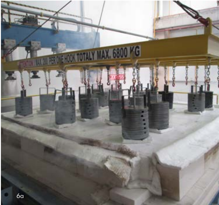
Şekil 5 - Yük Taşıyan Duvar Elemanı Testleri (Test Başlangıcı ve Sonu)
