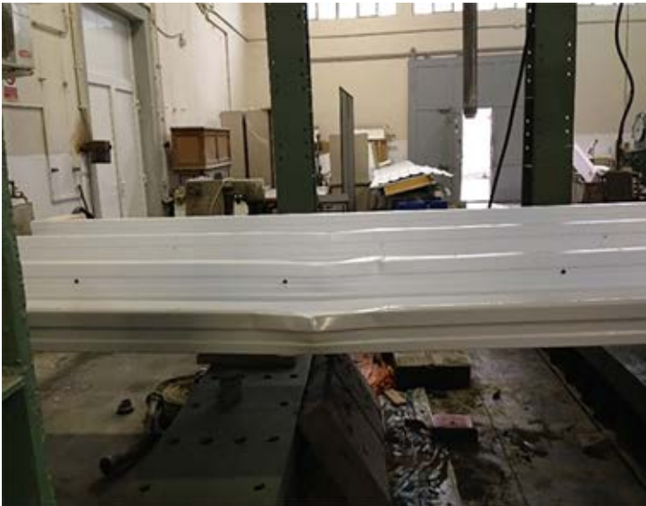
Şekil 21 - Test düzeneğinin nihai göçme mekanizması
