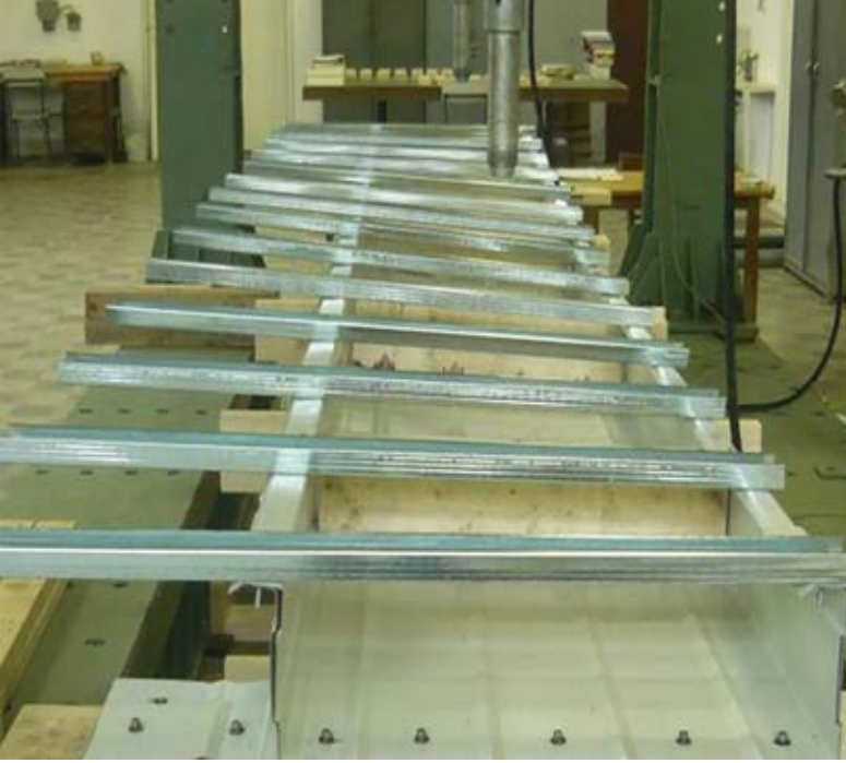
Şekil 7 - Orta açıklıkta tipik simetrik olmayan başarısızlık (dış kaplama üzerindeki rüzgâr basıncı)
