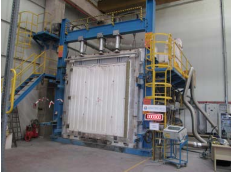
Şekil 5 - Yük Taşıyan Duvar Elemanı Testleri (Test Başlangıcı ve Sonu)
