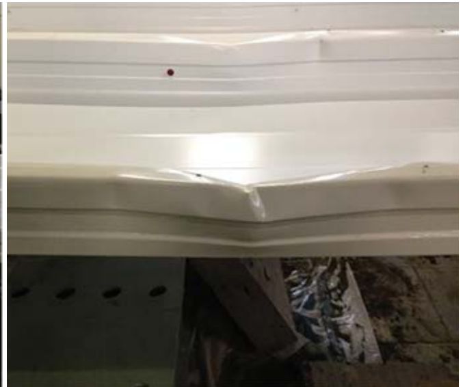
Şekil 21 - Test düzeneğinin nihai göçme mekanizması
