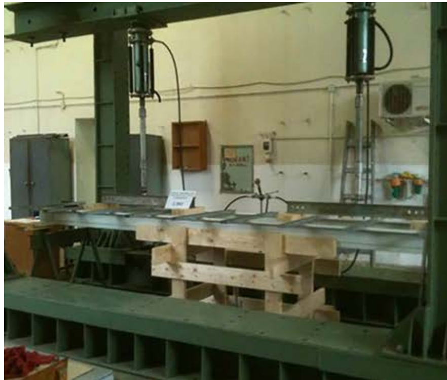
Şekil 3 - Rüzgâr basıncı için deney düzeneği
