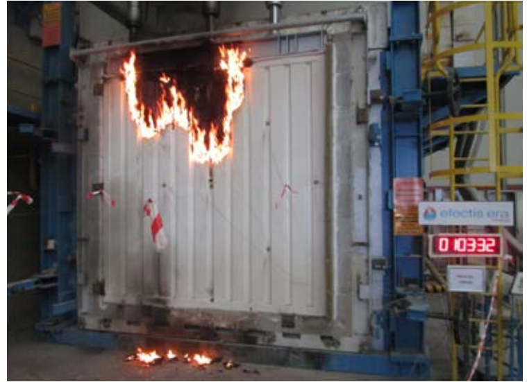
Şekil 5 - Yük Taşıyan Duvar Elemanı Testleri (Test Başlangıcı ve Sonu)
