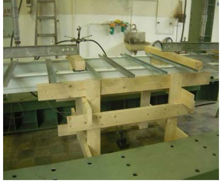
Şekil 4 - Numunenin yanal-burulma bükülmesini önlemek için orta açıklıklı ahşap donanım
