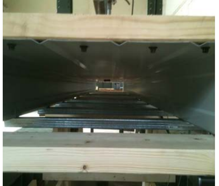
Şekil 4 - Numunenin yanal-burulma bükülmesini önlemek için orta açıklıklı ahşap donanım
