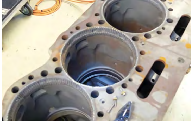
Şekil 16 - Lazer toz jet besleme tekniği ile aşınmış silindirlerin onarımı
