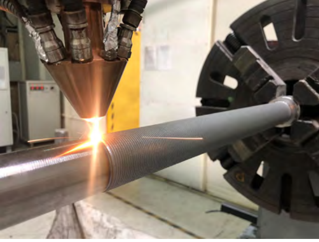
Şekil 15 - 4140 altlık üzerine lazer toz jet besleme tekniği ile 420 martenzitik paslanmaz çelik giydirilmesi 17
