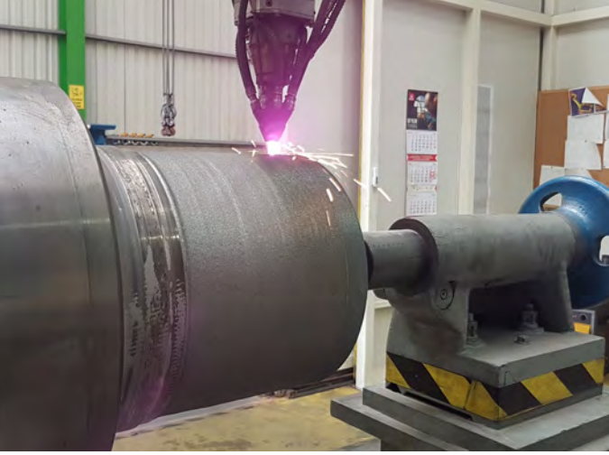
Şekil 17 - Hadde mili yatağının lazer giydirme ile kaplanması
