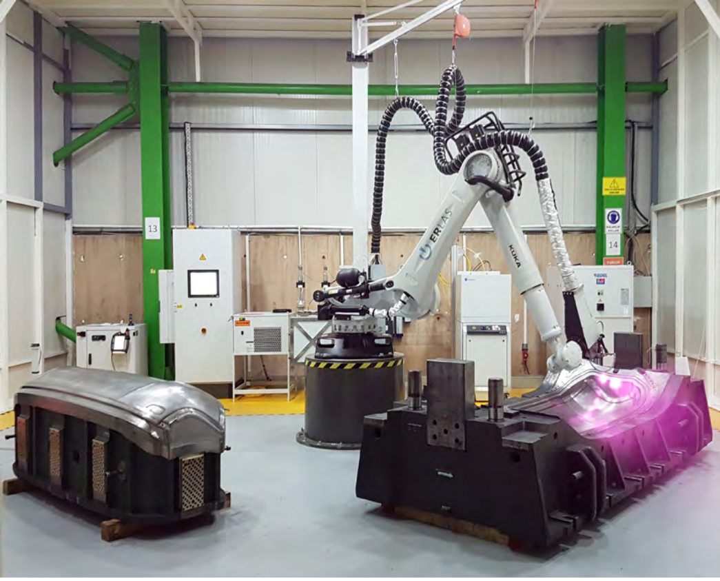
Şekil 6 - Robotik kollu modern lazer tesisinin görünüşü ve kalıp yüzeyinin sertleştirilmesi 7
