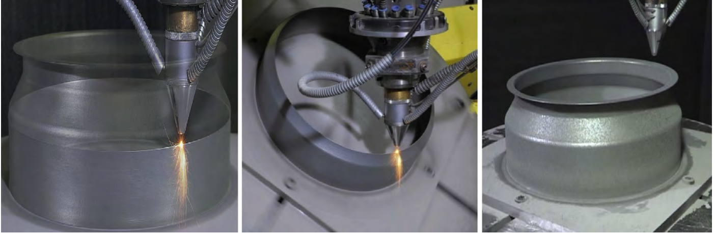
Şekil 20 - IN718 helikopter motoru yanma odası, 5 eksenli lazer metal biriktirme ile süreci ile üretilmesi 19
