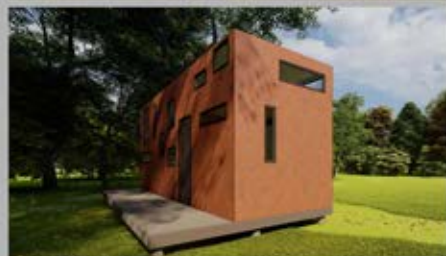
CEPHE TASARIMI DİŞ CEPHE MALZEMESİ KÖR-TEN ÇELİK OLARAK TERCİH EDİLMİŞ VE DÜNYANIN HER BÖLGESİNDEKİ HAVA ŞARTLARINA UYAN VE OKSİTLENEN YAPISIYLA ÇEVRESİNE UYUM SAĞLAYABİLEN DOKUSUYLA SÜRDÜRÜLEBİLİR OLMASI HEDEFLENMİŞTİR. TASARLANAN PENCERELER YAPI İÇERİSİNDEKİ BİRİMLERİN UYGUN İĞİİ ALABİLMESİ VE HAVA SİRKÜLASYONUNUN SAĞLIKLI OLABİLMESİ İÇİN BELİRLİ BİR DÜZENDE YERLEŞTİRİLMİŞTİR.
