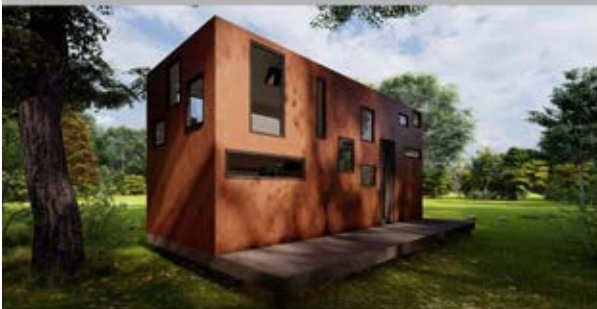
CEPHE TASARIMI DİŞ CEPHE MALZEMESİ KÖR-TEN ÇELİK OLARAK TERCİH EDİLMİŞ VE DÜNYANIN HER BÖLGESİNDEKİ HAVA ŞARTLARINA UYAN VE OKSİTLENEN YAPISIYLA ÇEVRESİNE UYUM SAĞLAYABİLEN DOKUSUYLA SÜRDÜRÜLEBİLİR OLMASI HEDEFLENMİŞTİR. TASARLANAN PENCERELER YAPI İÇERİSİNDEKİ BİRİMLERİN UYGUN İĞİİ ALABİLMESİ VE HAVA SİRKÜLASYONUNUN SAĞLIKLI OLABİLMESİ İÇİN BELİRLİ BİR DÜZENDE YERLEŞTİRİLMİŞTİR.
