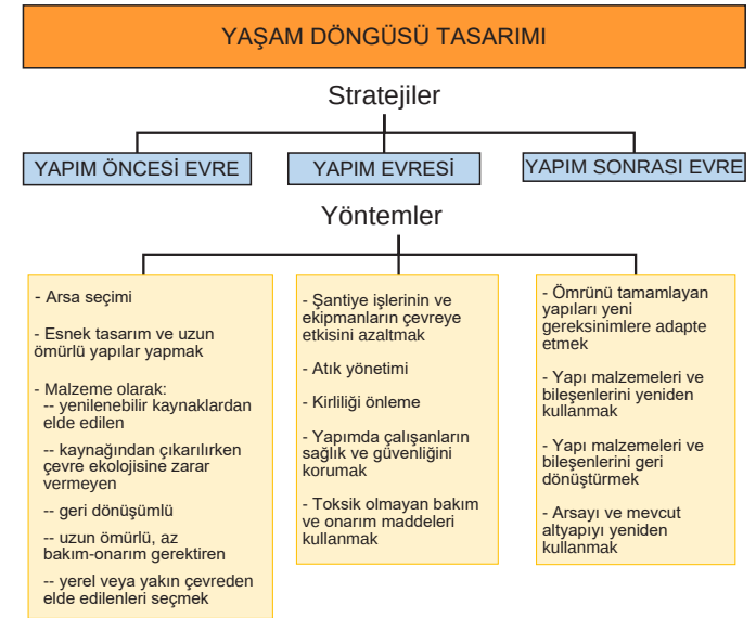
Şekil 1.5. Yapıların yaşam döngüsünde dikkate alınması gereken stratejiler ve yöntemler (Sev, A., 2009; Karaaslan, S., 2011'den uyarlanmıştır.)
