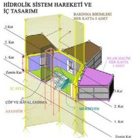
Şekil 1 - Hidrolik Sistem Tasarımında Dikey Sirkülasyon ve Modüler Birimlerle İlişki
