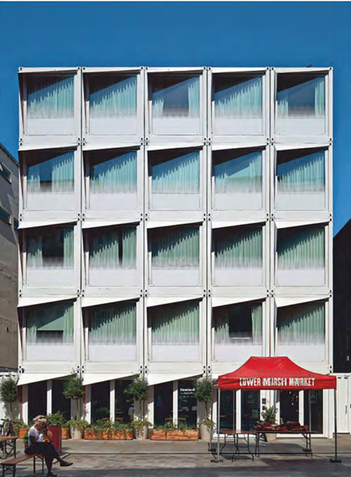
Şekil 20. Geri dönüştürülmüş deniz konteynerleri paslarından arındırılmış ve boyanmıştır (Kerr, 2020)
