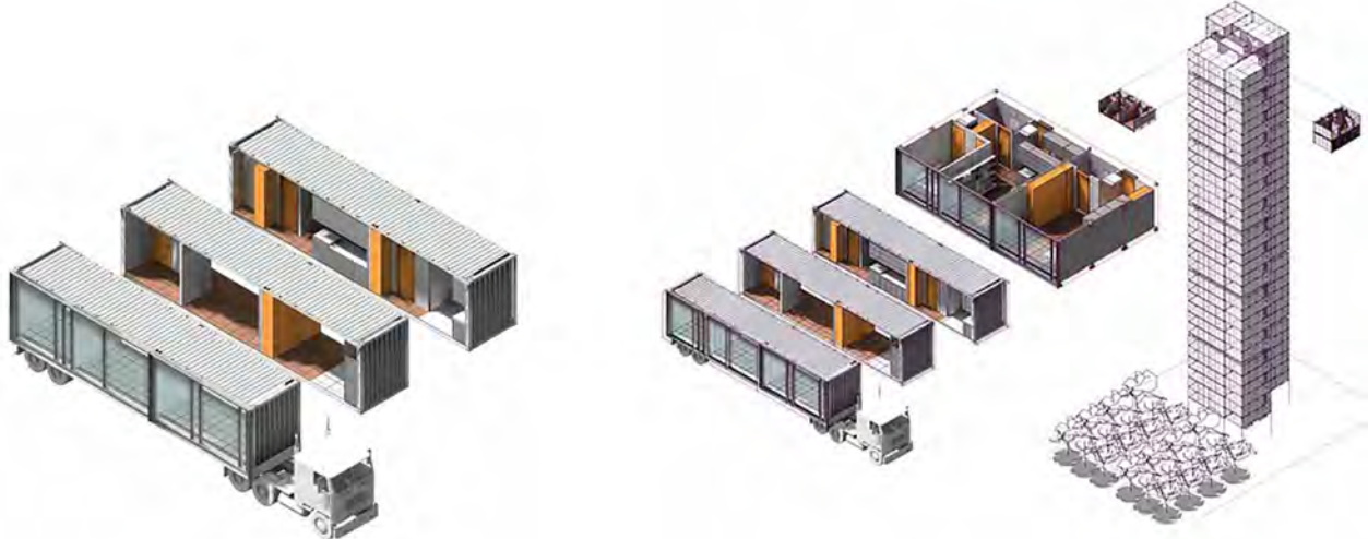
Şekil 6. Nakliye koşullarına uygun boyut ve ölçülerde modüller (Wallance, 2015)
