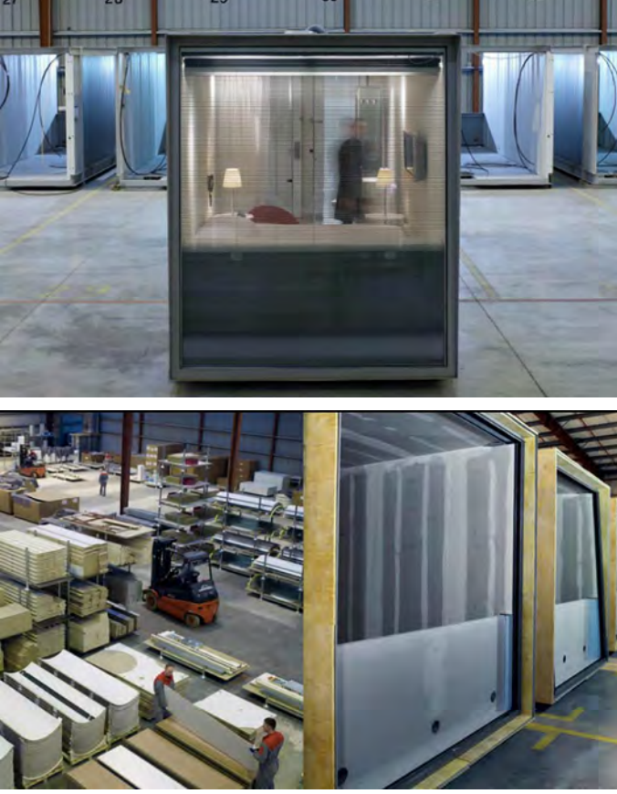
Şekil 26. Modüllerin fabrikada üretim süreci (Meinhold, 2012)
